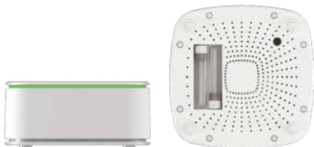
Ogni dispositivo ha una copertura di circa 80 mq. La batteria di back up ha una autonomia di 3 ore e la memoria interna può conservare fino a 60 giorni di rilevazioni.
